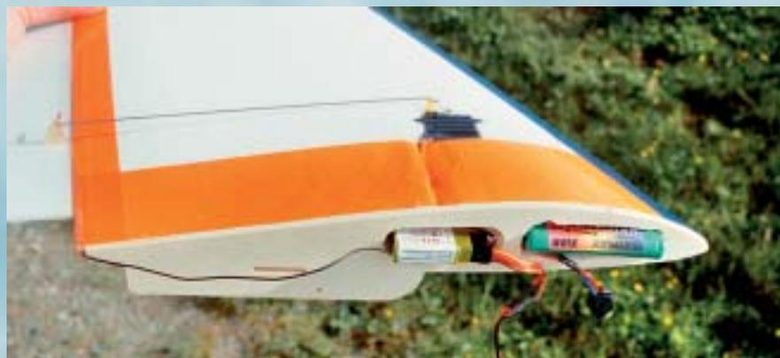
◀ Die Sperrholzrippe: sie bringt Stabilität, Empfänger und Akku sind schon eingebaut, die Stecker lässt man einfach unten herauschauen. Man beachte den Einbau der Antenne
