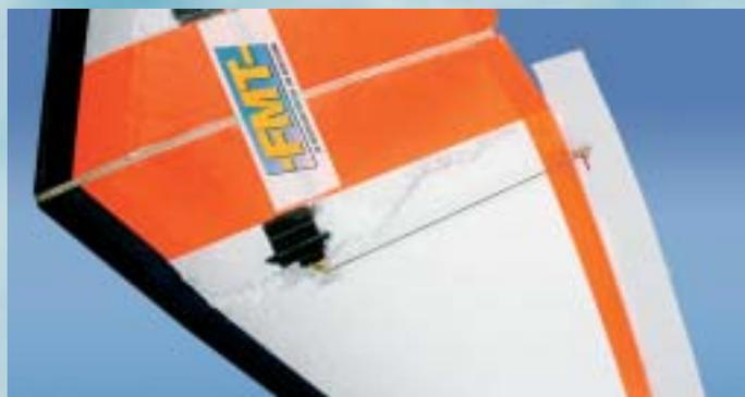
mit Harz oder einem anderen Klebstoffzusammengeklebt, sondern einfach mit ein paar Streifen Tesa-Film aneinander geklebt. So kommt man immer an den Empfänger und den Akku, ohne das Modell zerstören zu müssen. Wichtig ist, dass man nicht das schmalste und billigste Klebeband nimmt. Und die Empfehlung für Extremstarts einen Tesastreifen auf Ober- und Unterseite als Holm zu benutzen halten wir für zwingend notwendig. So, schnell die Ruderanlenkun-
