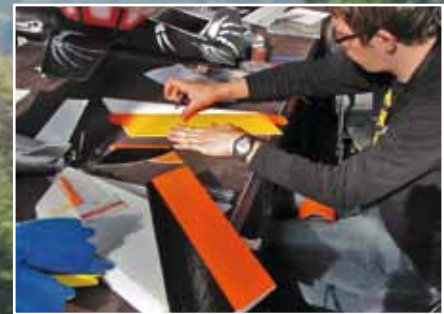
Eine Flächenhälfte und die Winglets sind schon fertig. Das Tapen des kompletten Modells dauerte 50 Minuten.
