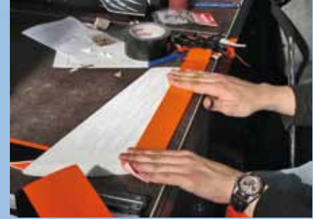
Die Flächenkerne werden komplett mit Tape überzogen. Beim Tapen immer auf eine ebene Unterlage achten.
