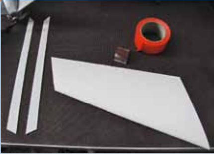
So kommen die Teile aus dem Karton: Exakt zugeschnittene Flächenkerne aus Styropor sowie Ruder und Winglets aus Depron.
