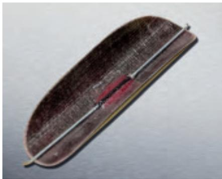
Die Haube wird per Stahldrahtmethode auf dem Rumpf gehalten, der Draht ist bereits fertig montiert.
