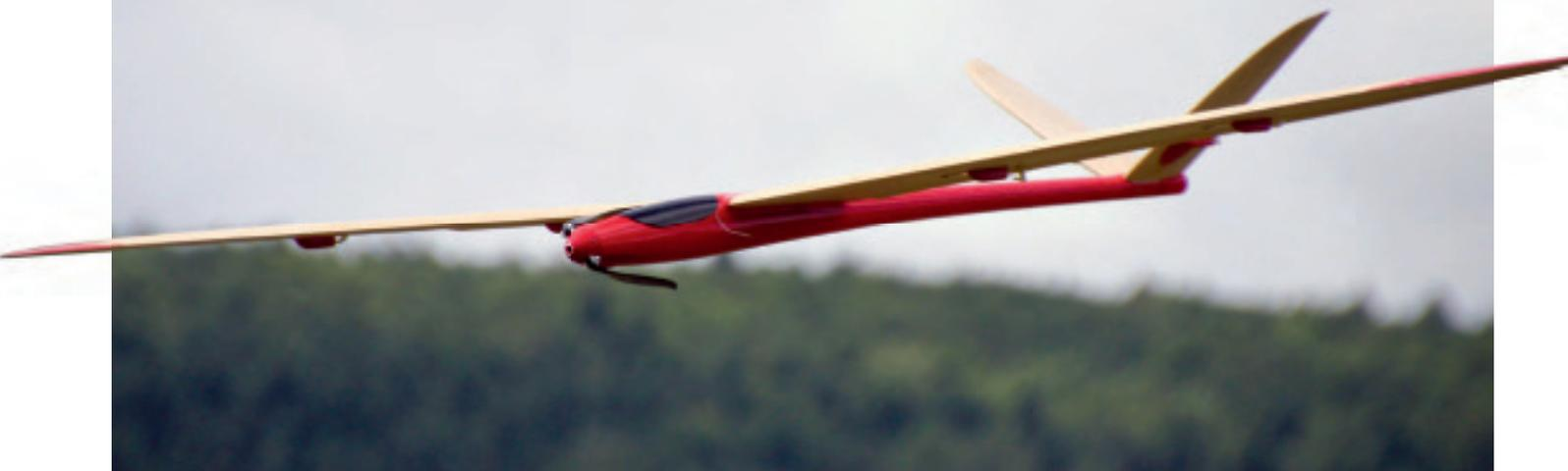
so dass der Antrieb ein erstes Mal abgestellt und die Trimmung des Modells überprüft werden konnte. Trimmkorrekturen waren kaum notwendig, der Fenrir lag von Anfang an ruhig in der Luft und vermittelte gleich ein vertrautes Gefühl am Knüppel. Die Ruderreaktion auf Höhen- und Seitenruder ist angenehm weich, aber dennoch exakt; auf dem Querruder reagiert der Fenrir deutlich direkter, weshalb hier – je nach persönlichen Vorlieben – ein paar Prozent Expo sicherlich nicht schaden können.
