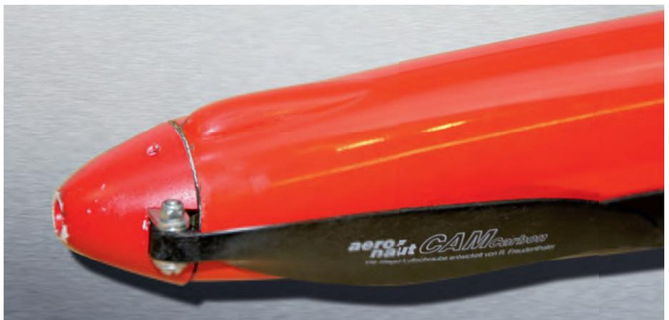
Die kleine Anfrummung am Rumpf ermöglicht es, die Kabel des Außenläufers elegant am Motor vorbei zu führen.
