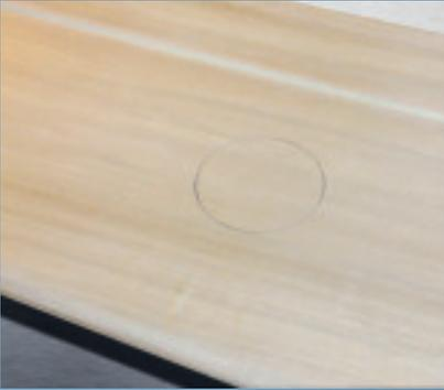
So sind die Servoschächte vorbereitet, der entsprechende Teil der Beplankung muss noch abgelöst und das darunter liegende Styro entfernt werden.
