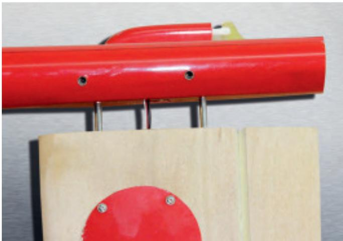
Das V-Leitwerk im Detail. Die Servoschachtdeckungen wurden selbst beschafft und mittels kleiner Schraubchen befestigt. Die Steckung am Rumpf geschieht über Stahldrähte.
