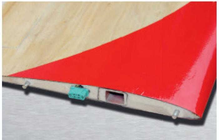
Hier sieht man schön die CFK-Einlage im Wurzelbereich, die Torsionsbolzen sind bereits fertig montiert, der MPX-Stecker wurde in Eigenregie verbaut. Das Design wurde aus Oracover-Klebefolie erstellt.
