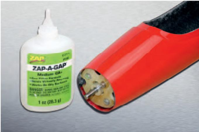
Der Motorspann wurde mit Sekundenkleber eingepasst und dann mit Epoxi verklebt.
