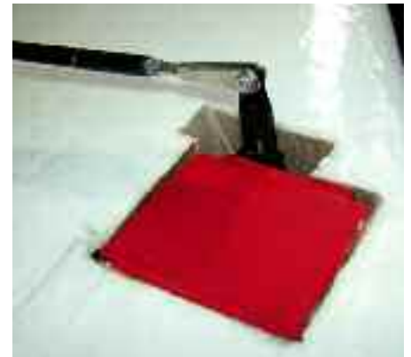
◀ In der rechten Flügelhälfte finden der 1.050 mAh NiMH-Akku und ein Empfänger Webra Nano S6 ihre Plätze. Ganz vorn verschwindet in jeder Flügelhälfte noch ein Streifen Trimmblei (jeweils 45 g).
