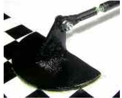
▲ Die Ruderhörner sitzen auf halbrunden Sperrholzbrettchen. Hier ist auf eine stabile Klebeverbindung zu achten, da aufgrund der Größe der Querruder gewaltige Stellkräfte übertragen werden müssen.
