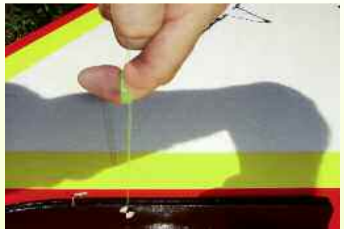
▼ Zweckmäßigerweise haben die Küstenflieger auf der Unterseite der beiden Wurzelrippen Bohrungen zum Auswiegen des Schwerpunkts angebracht. Die Kontrolle erfolgt mittels Nylonfaden. ▼
