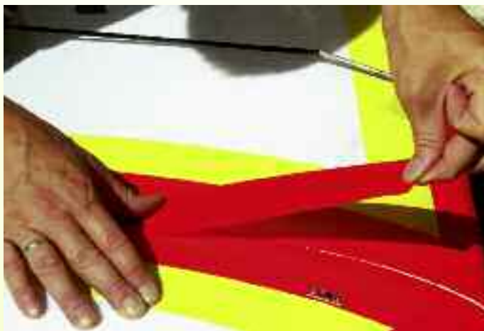
Die beiden Flügelhälften werden lediglich durch Klebebandstreifen miteinander verbunden. Keine Angst – das hält!
