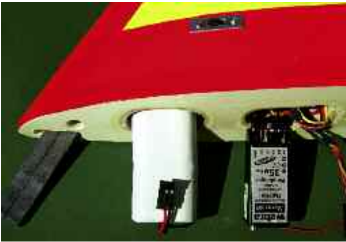
Die Servos tauchen vollständig in der Flügel Nase unter – nur die Ruderarme sind sichtbar. ▶
