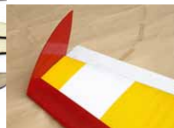
Die Depron-Winglets bekommen auf beiden Seiten einen Überzug mit dem Tape. Anschließend werden sie mit Fünfminuten-Epoxydharz angeklebt
