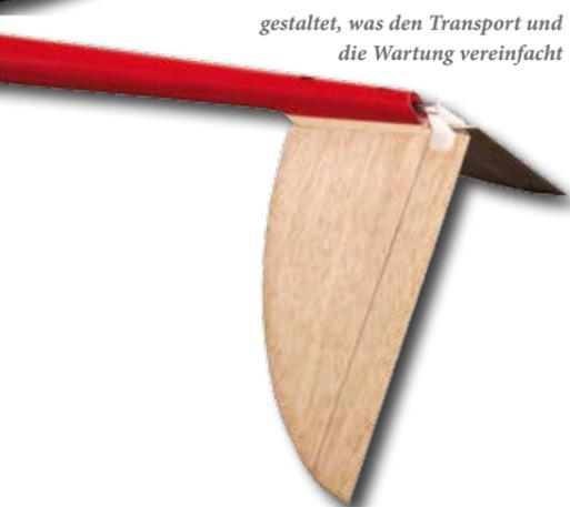
den Sitz und den V-Winkel vorgibt. Laut Anleitung sollte man das Leitwerk jetzt mit Bügelfolie bespannen. Beim Testmodell wurde es lediglich mit Glattfix Porenfüller vorbehandelt, und danach mit einer Schicht Spannlack versiegelt.
