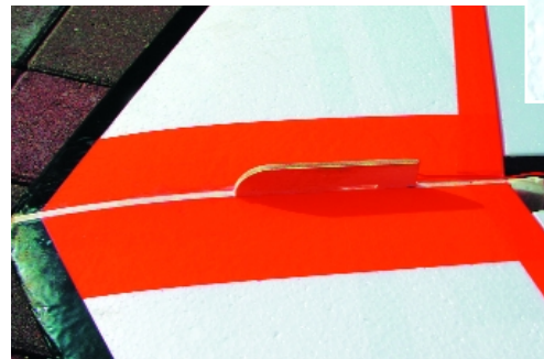
Die verlängerte Sperrholzrippe dient als Haltegriff beim Start
