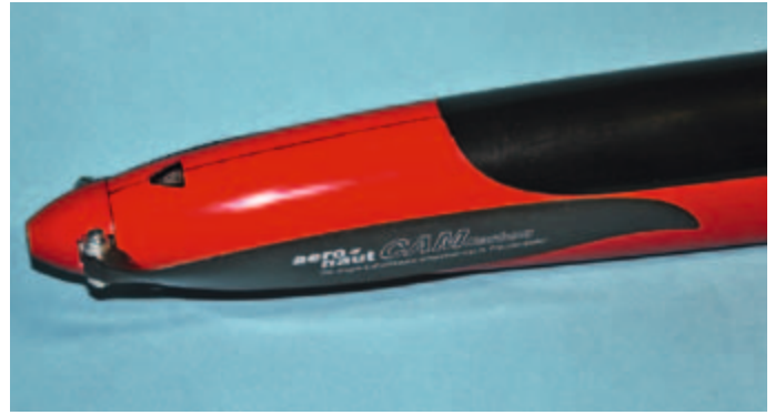
Segler- und Elektronase im Vergleich. Für den ziemlich schlanken Rumpfquerschnitt eignen sich Innenläufer-Antriebe mit Getriebe. Man beachte die Schleppkupplungsöffnung beim Seglerrumpf.
