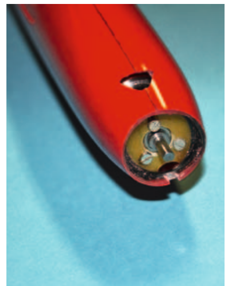
Der Motorspant besteht aus 2-mm-GFK und wurde nach dem Einkleben mit Rovings verstärkt.
