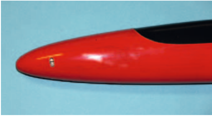
Segler- und Elektronase im Vergleich. Für den ziemlich schlanken Rumpfquerschnitt eignen sich Innenläufer-Antriebe mit Getriebe. Man beachte die Schleppkupplungsöffnung beim Seglerrumpf.
