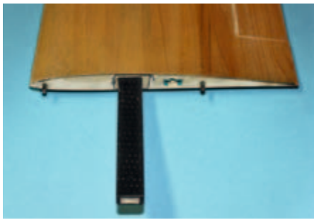
Der aus CFK laminierte Vierkant-Flächenverbinder ist solide dimensioniert und gibt auch die V-Form vor.
