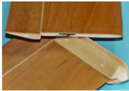
Die beiden Leitwerkshälften werden durch einen GFK-verstärkten Holzblock verbunden.
